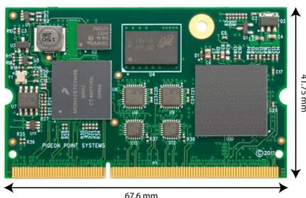
SCHROFF Pigeon Point-Mezzanine-Modul für ATCA-Systeme (ShMM-700R) und VPX-Chassis (ChMM-700R)
