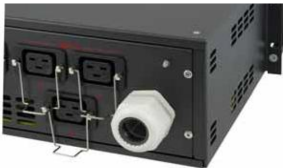
Rückseite: Stecker-Haltebügel und Kabelverschraubung
