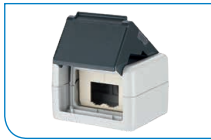
IP44-Aufputzgehäuse für 2 Einzelmodule der Bauform Keystone. IP44-Schutz nur im geschlossenen Zustand (ohne gestecktes Patchkabel)
