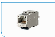
C6A modul K 180 Grad modulare Cat.6 A Anschlusseinheit RJ45 Bauform: Keystone, Kabelzuführung 180° Art.-Nr.: 130B21-E / 130B21-Z (VE: 12 St.)
