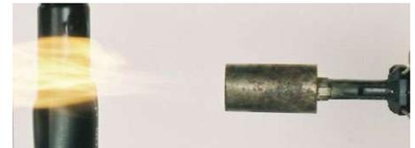
Die Schrumpfung der Isolierung erfolgt mittels Wärmezufuhr.
