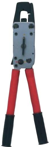
Mechanische Handcrimpzange zum Crimpen von Cu-Verbindern vom Typ KR/KS 10 mm<sup>2</sup>, KRF/KSF 16-95 mm<sup>2</sup>, KR/DS 16-120 mm<sup>2</sup>, KRT/KST 10-120 mm<sup>2</sup>, Al-Verbindern 16-25 mm<sup>2</sup> (-35 massiv), C-Hülsen 6/6-50/50 mm<sup>2</sup> und DIN 46235 10-95 mm<sup>2</sup>.
