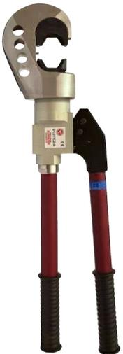
Geprüfte und zertifizierte hydraulische Handcrimpzange zum Crimpen von Cu-Verbindern vom Typ KR/KRT 10 mm<sup>2</sup>, KS/KST 10 mm<sup>2</sup>, KRF/KRD/KRT 16-400 mm<sup>2</sup>, KSF/KSD/KST 16-400 mm<sup>2</sup>.
