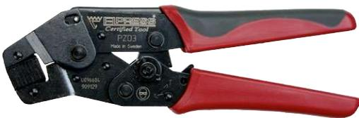
Geprüfte und zertifizierte mechanische Handzange zum Crimpen von Aderendhülsen 0,5-6 mm<sup>2</sup> und isolierten TWIN-Aderendhülsen 2x0,5-2x4 mm<sup>2</sup>.
