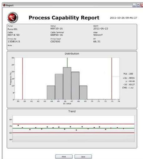
Analyzer, zur Messung und Analyse jedes einzelnen Crimpvorgangs.
