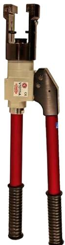
Geprüfte und zertifizierte hydraulische Handcrimpzange zum Crimpen von Cu-Verbindern vom Typ KRF/KSF 10-400 mm<sup>2</sup>, Al-Verbindern 16-400 mm<sup>2</sup> (-240 massiv) und C-Hülsen bis zu einem Gesamtquerschnitt von 240 mm<sup>2</sup> (C95-120).
