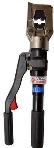
Geprüfte und zertifizierte hydraulische Handcrimpzange zum Crimpen von Cu-Verbindern vom Typ KR/KS 10 mm<sup>2</sup>, KRF/KSF 16-150 mm<sup>2</sup>, KR/DS 16-185 mm<sup>2</sup>, KRT/KST 10-240 mm<sup>2</sup>, Al-Verbindern 16-25 mm<sup>2</sup> (-35 massiv), C-Hülsen 6/6-50/50 mm<sup>2</sup>, DIN 46235 10-95 mm<sup>2</sup>.
