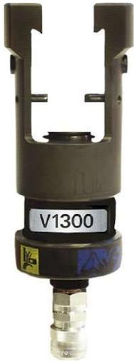
Geprüfter und zertifizierter Crimpkopf zum Crimpen von Cu-Verbindern vom Typ KR/KRT 10 mm<sup>2</sup>, KS/KST 10 mm<sup>2</sup>, KRF/KRD/KRT 16-400 mm<sup>2</sup>, KSF/KSD/KST 16-400 mm<sup>2</sup>, Al-Verbindern 16-400 mm<sup>2</sup> (-240 massiv) und C-Hülsen bis zu einem Gesamtquerschnitt von 240 mm<sup>2</sup> (C95-120). Verwendung mit Fußpumpe P4000 oder elektrischer Pumpe PS710 (PS710E auch als akkubetriebene Ausführung erhältlich).
