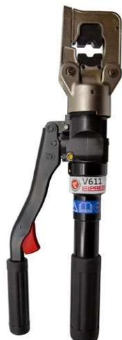
Geprüfte und zertifizierte hydraulische Handcrimpzange zum Crimpen von Cu-Verbindern vom Typ KR/KS 10 mm<sup>2</sup>, KRF/KSF 16-150 mm<sup>2</sup>, KR/DS 16-185 mm<sup>2</sup>, KRT/KST 10-240 mm<sup>2</sup>, Al-Verbindern 16-25 mm<sup>2</sup> (-35 massiv), C-Hülsen 6/6-50/50 mm<sup>2</sup>, DIN 46235 10-95 mm<sup>2</sup>.
