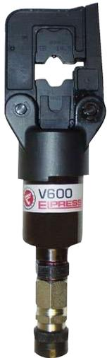
Geprüfter und zertifizierter Crimpkopf zum Crimpen von Cu-Verbindern vom Typ KR/KS 10 mm<sup>2</sup>, KRF/KSF 16-150 mm<sup>2</sup>, KR/DS 16-185 mm<sup>2</sup>, KRT/KST 10-240 mm<sup>2</sup>, Al-Verbindern 16-25 mm<sup>2</sup> (-35 massiv), C-Hülsen 6/6-50/50 mm<sup>2</sup> und DIN 46235 10-95 mm<sup>2</sup>.
