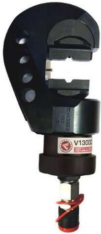
Crimpkopf zum Crimpen von Cu-Verbindern vom Typ KR/KRT 10 mm<sup>2</sup>, KS/KST 10 mm<sup>2</sup>, KRF/KRD/KRT 16-400 mm<sup>2</sup>, KSF/KSD/KST 16-400 mm<sup>2</sup>. Verwendung mit Fußpumpe P4000 oder akku- bzw. netzbetriebener Pumpe PS710 (PS710E auch als akkubetriebene Ausführung erhältlich).
