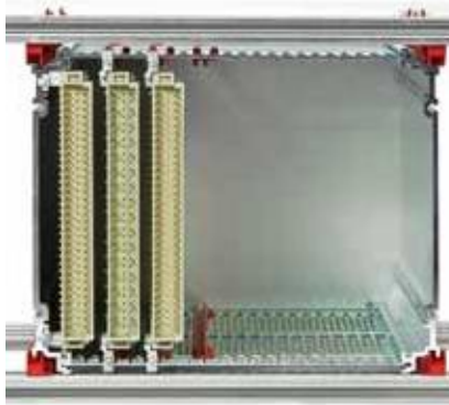
Rückansicht: Kasette in Baugruppenträger eingebaut
